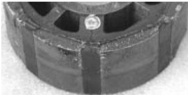
Слика 4.1.4. Ротор мотора са магнетима различите величине
