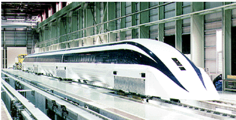
Slika 7 MLX01-901 vodeća kola, dizajnirana specijalno za smanjenje otpora vazduha pri velikim brzinama
