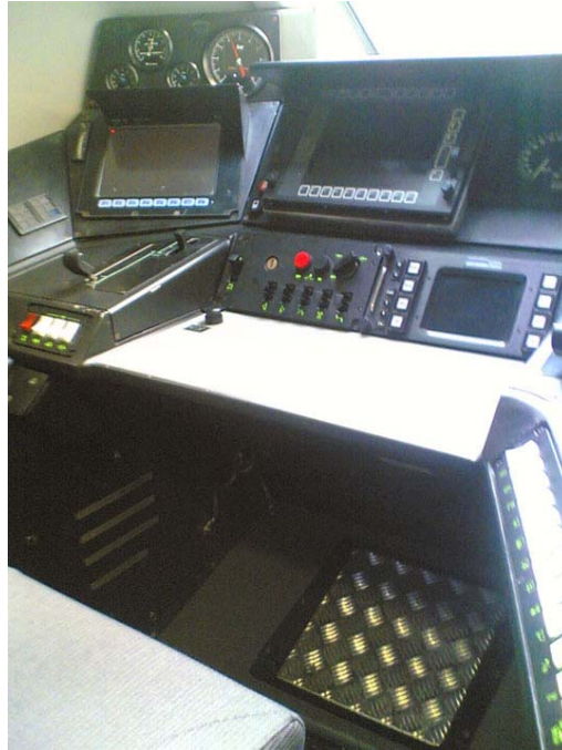
Slika 7. Kabina lokomotive opremljena radio alarmnim uređajem „VACMA“. U donjem delu se vidi pedala SKB uređaja.
