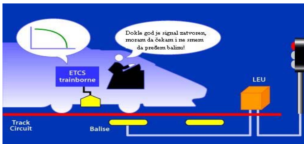
Slika 17. Grafički prikaz funkcionisanja ETCS-a prvog nivoa.
