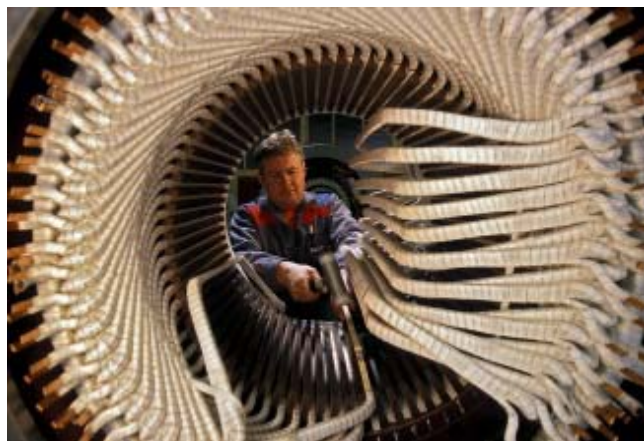
Slika 4. Motanje namotaja statora
