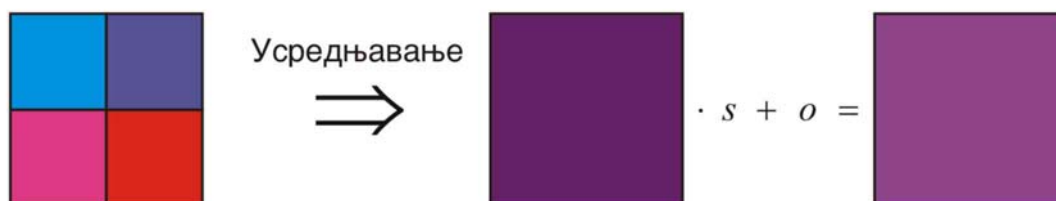
Сл. 3.2. Процес добијања оптималне вредности пиксела већег дела слике
