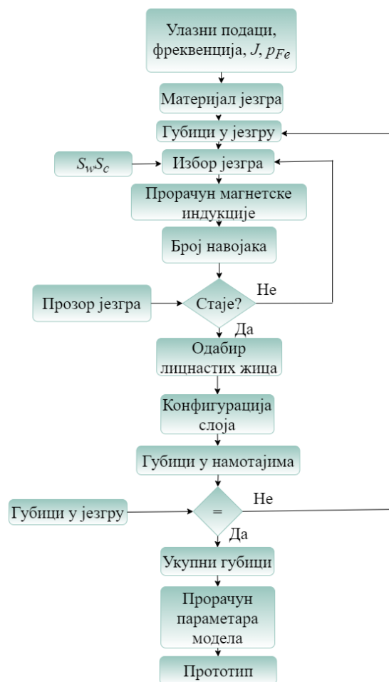
Слика 3. Алгоритам за дизајн високофреквентног трансформатора
