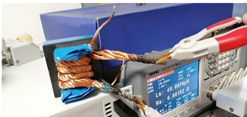
Слика 13. Оглед празног хода вршеног са примарне стране коришћењем LCR метра
